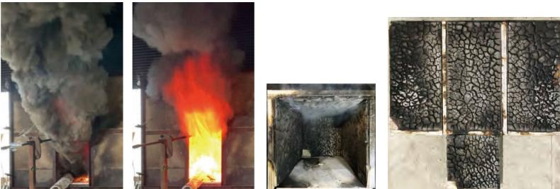
※ 有機化合物である発泡プラスチックは、不燃材料の認定を取っていても燃焼リスクがありますので「火気厳禁」となります。一旦燃焼が始まると、難燃処理していない製品と同様に、黒煙を出して激しく燃えることがあります。不燃ウレタン(不燃材料認定品)であっても“あらわし”での仕上げは火災リスクが高まります。
